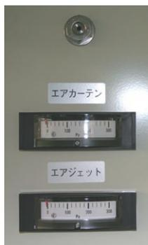
HEPAフィルタの目詰まり・寿命判断等の為にフィルタの差圧を測定します。（バリデーション対応型は差圧計標準装備）
