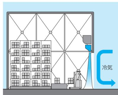
●完成品や部品の保管倉庫の入口に温水(蒸気)ヒータ付エアカーテンを設置し冷気を遮断します。
