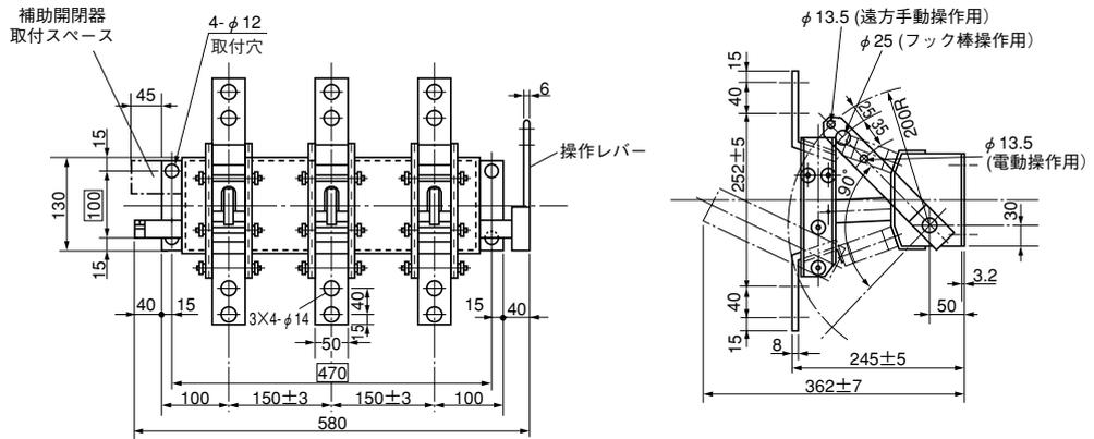
(注) 操作レバーは左側にも簡単に取付可能です。左操作とした場合、補助開閉器は右側面に取付となります。
