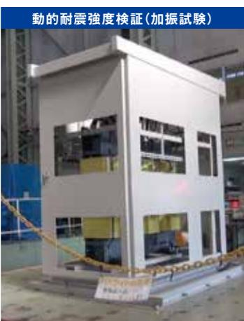
より優れた安全性の確証として「配電用変圧器の変位量抑制指針」JEM-TR 252に準拠し、静的耐震強度、端子の変位量を転倒試験により検証しています。また独自の検証として、実際の地震波を用いて動的耐震強度を確認。工場はもちろん、高層ビル、公共施設、病院、ホテルなどの様々な場所で安全性の向上に努めています。
