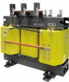
スコット結線変圧器の二次側は位相の90度異なった2つの単相回路が得られます。2つの単相負担が等しいとき一次側は平衡三相電流となるため、電源側の三相発電機に悪影響を与えません。なのでビルや工場などの非常用電源として使用されています。
