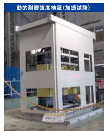
より優れた安全性の確認として「配電用変圧器の変位量抑制指針」JEM TR 252:2014に準拠し、静的耐震強度、端子の変位量を転倒試験により検証しています。また独自の検証として、実際の地震波を用いて動的耐震強度を確認。工場はもちろん、高層ビル、公共施設、病院、ホテルなどの様々な場所で安全性の向上に努めています。
