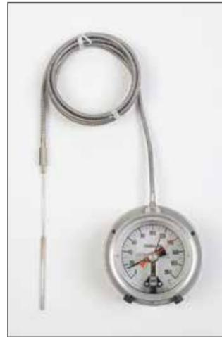
ダイヤル温度計は、コイルの温度を直接測定、表示します。感温部は低圧コイル直埋式で、温度精度および応答性が良好です。
