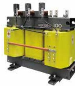
スコット結線変圧器の二次側は位相の90度異なった2つの単相回路が得られます。2つの単相負担が等しいとき一次側は平衡三相電流となるため、電源側の三相発電機に悪影響を与えません。なのでビルや工場などの非常用電源として使用されています。
