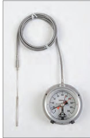
ダイヤル温度計は、コイルの温度を直接測定、表示します。感温部は低圧コイル直埋式で、温度精度および応答性が良好です。
