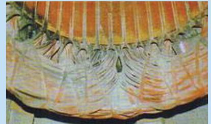
ダスト付着により絶縁破壊したモートル
