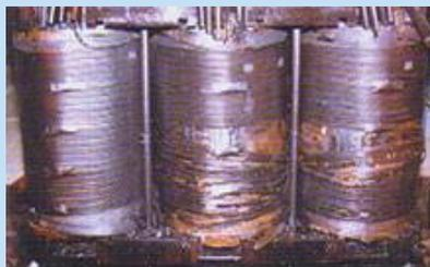
絶縁紙劣化によりコイルが破損した変圧器
