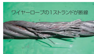
経年劣化により断線した ホイストワイヤーロープの例
