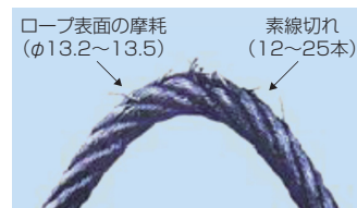
経年劣化により素線切れした ホイストワイヤーロープの例
