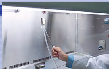
HEPAフィルタリーク試験
