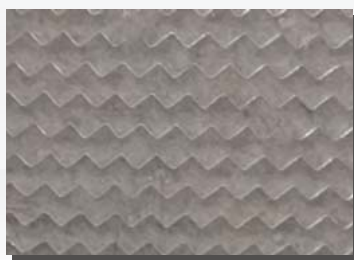
目詰まりしたHEPAフィルタ
