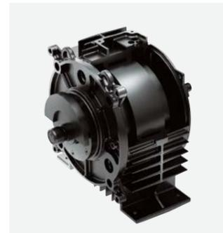
アモルファス合金をモータの鉄心に採用し、電力変換のロスを抑えた高効率・高トルクのモータ(IEC規格で規定された最高効率クラスであるIE5相当の効率)
